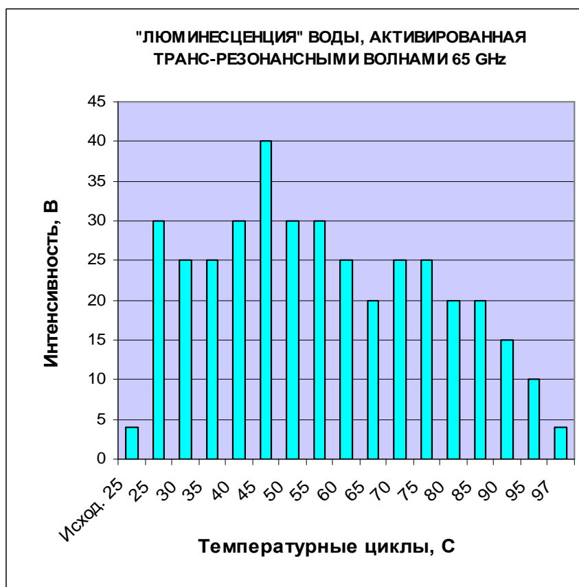
Рис. 3. Гистограмм температурной зависимости «люминесценции» дистиллята воды.
