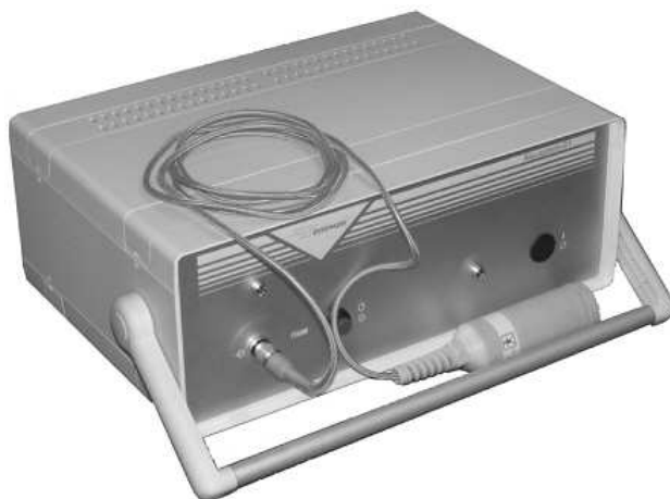
Рис.1. Диагностирующий комплекс «Аквафон».
